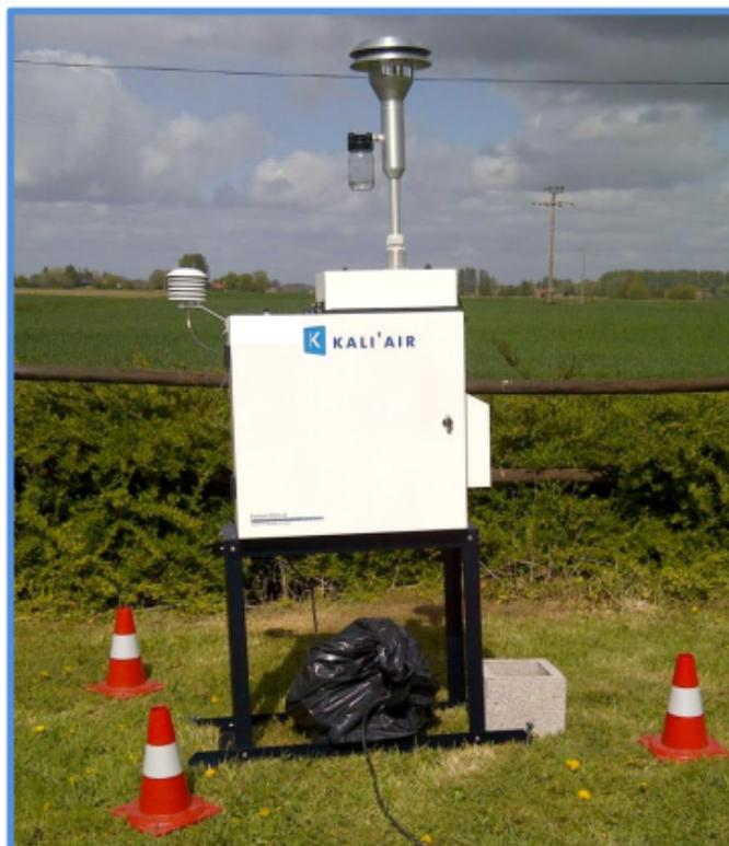
L'impaction classique consiste à accélérer un flux d'air chargé de particules au moyen d'une buse calibrée, puis d'intercaler une plaque de collection dans le jet d'air. Les particules les plus grosses dont l'inertie dépasse une certaine valeur, ne peuvent pas suivre les filets d'air et s'impactent sur la plaque de collection. Les particules plus fines contournent la plaque et suivent le flux d'air.
